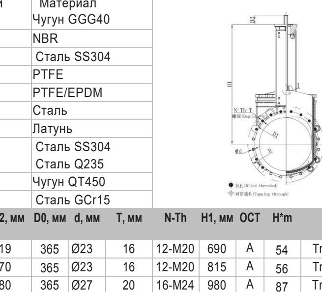
Длины и номинальные диаметры болтов и шпилек для фланцевых соединений шиберных задвижек
